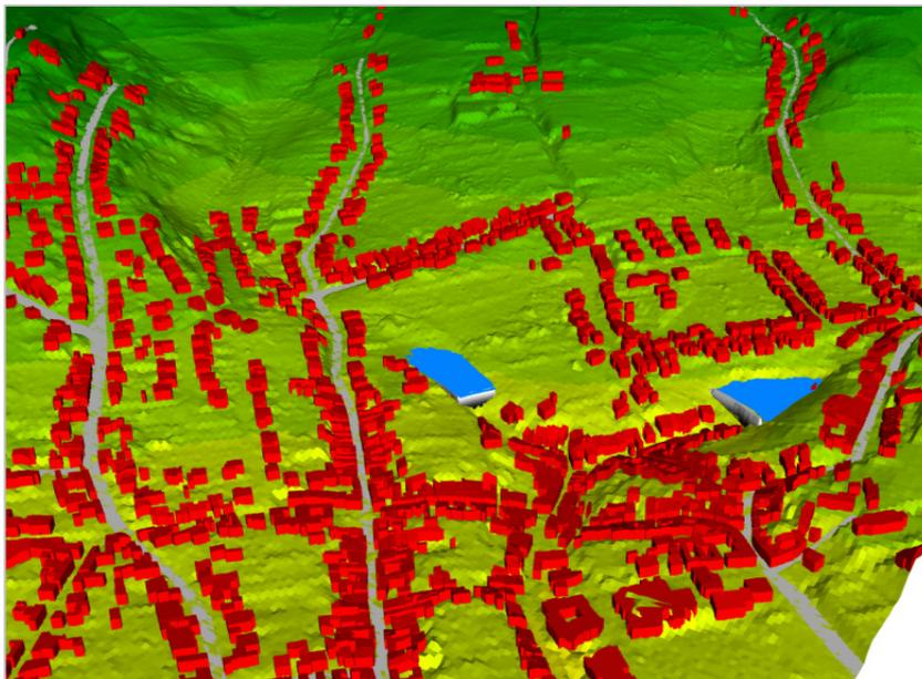
Abbildung 8.36: Lage der Becken Olsdorf und Broichpark mit Darstellung der möglichen Wasserflächen bei Einstau
